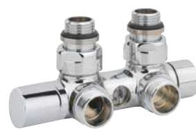
Gruppo valvola termostatizzabile/detentore cromato, interasse 50mm, compatibile con raccordi per tubi rame, multistrato e ferro, per impianti monotubo e bitubo.
