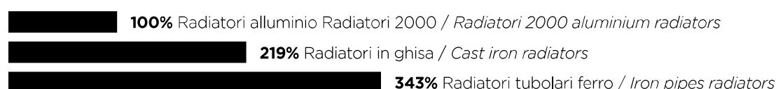
Quantità d'acqua a parità di resa termica / Quantity of water at equal thermal efficiency
