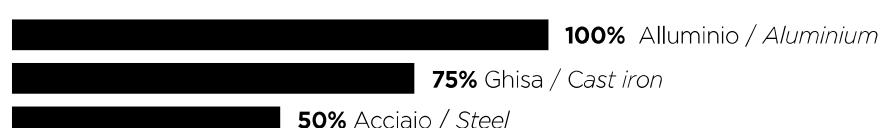
Flessibilità termica  $\Delta t = 50^{\circ}\text{C}$  / Heating flexibility  $\Delta t = 50^{\circ}\text{C}$
